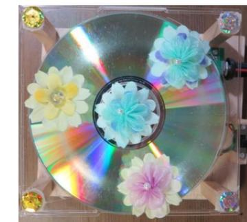
ギヤードモーターとフェライト磁石を使ってCD盤の上で花を回します。また、モーターコントローラーやスイッチを使い、回転の速さや回る向きも変えることができます。
