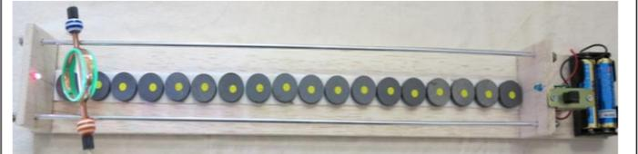
フェライト磁石の磁力とエナメル線を巻いたコイル（回転子といいます）の電磁石の力で動きます。電気の流れる向きをスイッチで変えると、動きが反対になります。
